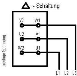
**Käfigläufer mit einer Drehzahl:**
