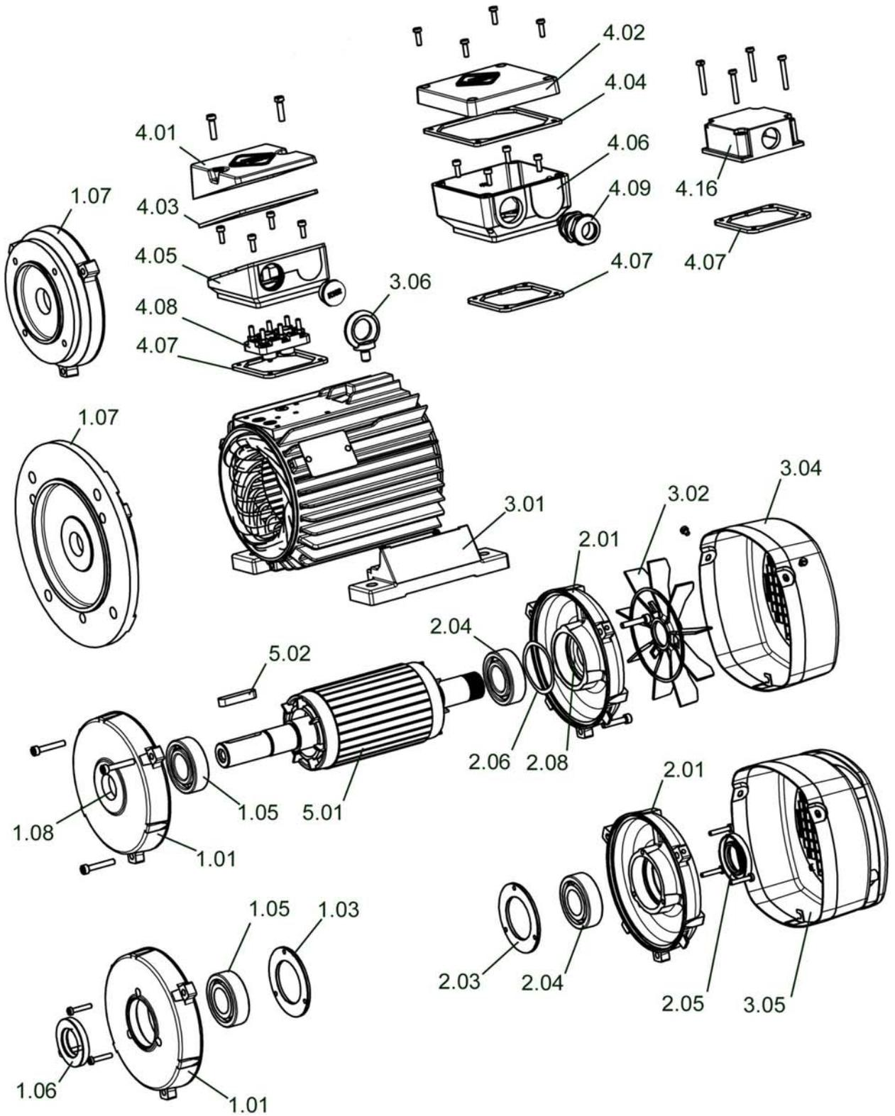
Drehstrom-Asynchronmotor / Grundaufbau K1.R / K2.R 112 - 355
