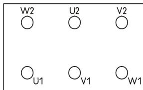
bei Sterndreieckschalter ohne Brücken Anschluss nach Schema des Schalters
