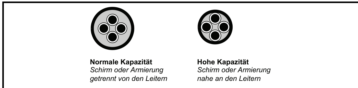
Abbildung 4-4 Einfluss der Kabelkonstruktion auf die Kapazität
