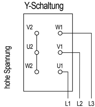
Bei Verwendung eines Stern-Dreieck-Schalters sind die Stern- bzw. Dreieck-Verbindungen zu entfernen.
